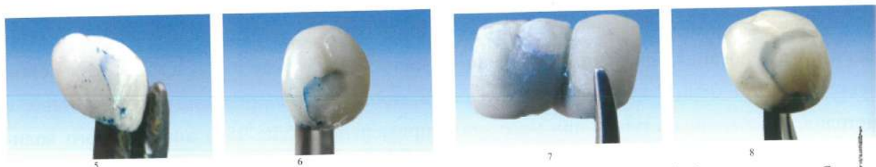
Рис. 2 Микротрещины на поверхности опакowego слоя из массы Noritake после ее обжига в вакуумной печи.
